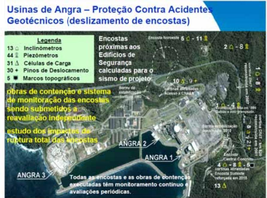
Central Nuclear Almirante Álvaro Alberto – posicionamento dos sensores geotécnicos
